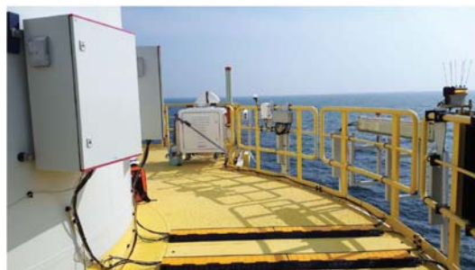
TP搭載スキャニングライダー (Carbon Trust ガイドラインより引用)
