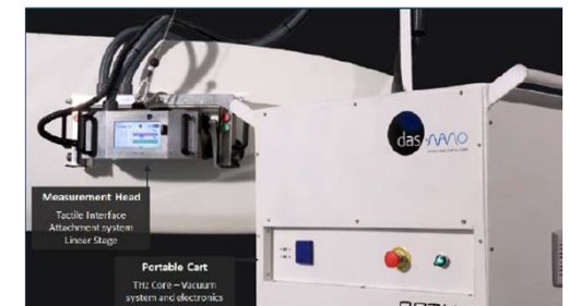
ブレードの テラヘルツスキャン検査
