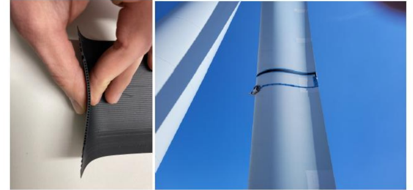
翼面圧力分布を計測するための圧力ベルト
